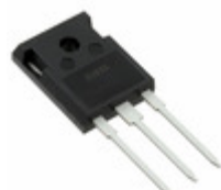
IXFH20N50P3 IXYS MOSFET N-CH 500V 20A TO-247
