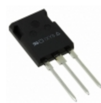
IXGR40N60C2D1 IXYS IGBT 600V 56A 170W ISOPLUS247
