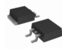
C3D08060G Cree/Wolfspeed DIODE SCHOTTKY 600V 8A TO263-2
