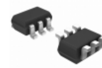
SGA-4563Z RF Solutions IC AMP HBT SIGE 2500MHZ SOT-363
